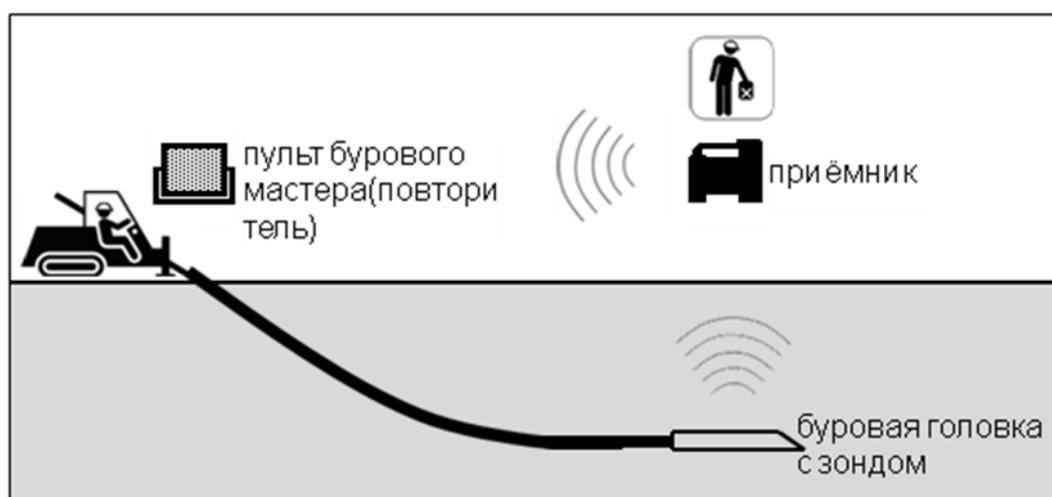
Навигационный приемник определяет местоположение (локацию) буровой головки путем векторного анализа силовых линий переменного магнитного поля, формируемого передающей антенной установленного зонда. Характер распределения силовых линий позволяет определить две характерные точки, называемые «передней» и «задней» точками локации и одну характерную линию, посредством которых и определяется истинное положение зонда
