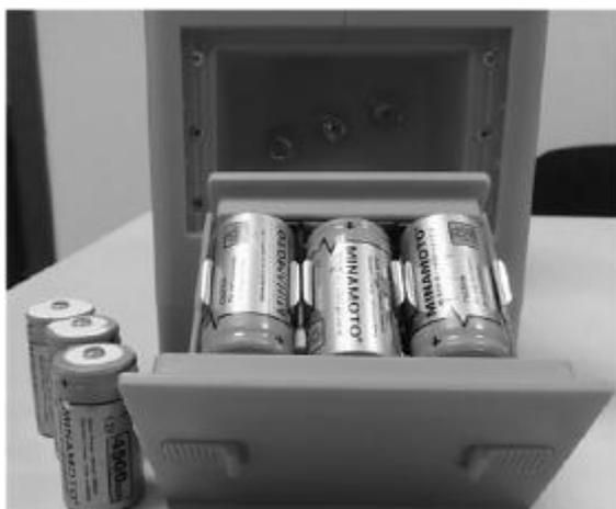
Рис. 1 Установка батареек
